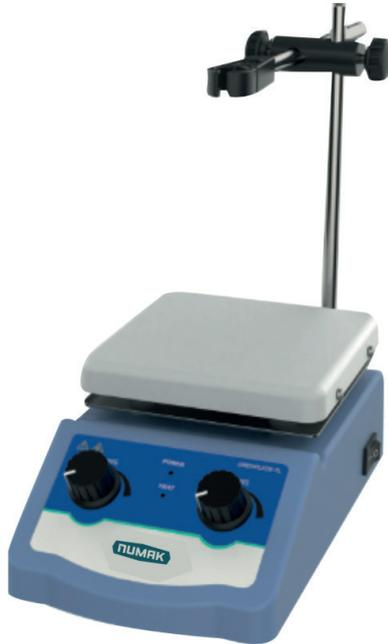
Este instrumento se utiliza principalmente en laboratorios para mezclar de manera automatizada un solvente y uno o más solutos. Al ser calefaccionado aumenta su versatilidad y eficiencia.
