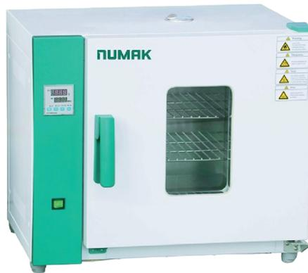
Se utiliza principalmente para el secado de materiales y esterilización instrumental en laboratorios y centros de investigación. Gracias a su sistema de movimiento constante de aire, asegura uniformidad de temperatura en toda la cámara de trabajo, sin sobrecalentamiento ni radiación directa.
